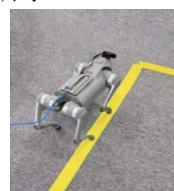
图11. 机器狗的自动巡线模式
