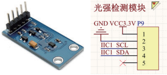
图 4. 光照强度检测模块实物图与电路图
