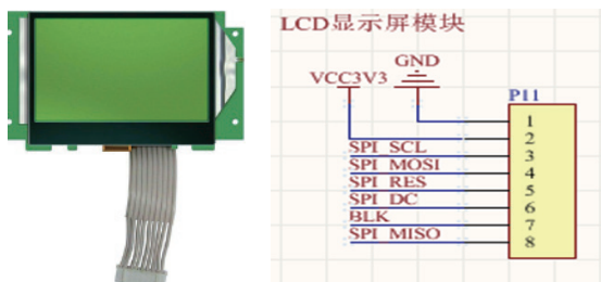
图 7. LCD 显示模块实物图与电路图
